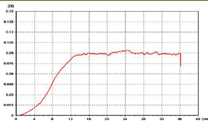
Courbe de la force de désolidarisation sur un déplacement de plusieurs cm. On peut remarquer que lorsque la qualité de vulcanisation est bonne (comme dans cet essai), la force de désolidarisation est constante, avec une force moyenne de désolidarisation de 9DaN pour une largeur de bande de 100mm.
